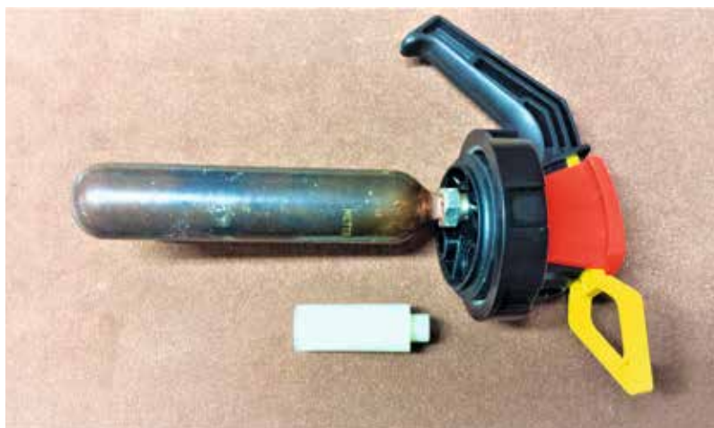
Im Feuerlöscherkopf heute noch verbaute Stahlkartusche im Vergleich zum Nitrocellulose-DGG
